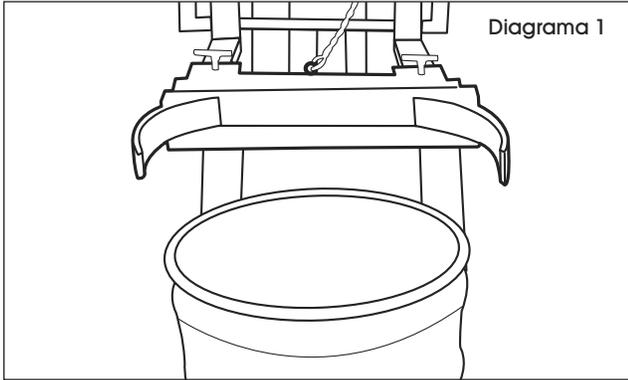
2. Lentamente baje las horquillas para colocar las abrazaderas del transportador de tambo en el centro del tambo, deteniéndose justo debajo del anillo elevado. (Vea Diagrama 2)
