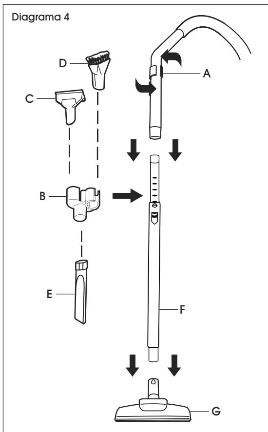
5. La extensión telescópica (F) se ajusta a diferentes alturas para limpiar. La combinación de la herramienta para piso (G) trabaja tanto en alfombras como en superficies duras moviendo la manivela en la herramienta para piso ya sea en la posición para alfombras o para suelo duro. (Vea Diagrama 4)
