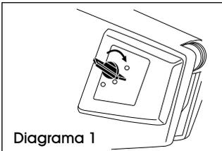
1. Gire el seguro para liberar la puerta del rodillo de tinta y jale cuidadosamente el rodillo de tinta completamente fuera de la etiquetadora. (Vea Diagrama 1)
