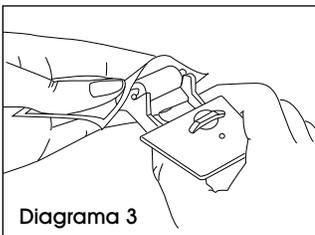
3. Corte el extremo del empaque del rodillo de tinta. Usando el paquete para proteger los dedos, deslice el cargador dentro del empaque y ponga el rodillo de tinta nuevo en su lugar. (Vea Diagrama 3)
