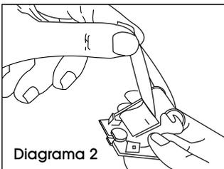
2. Inserte el respaldo de papel doblado entre el rodillo de tinta y el cargador. Jale para sacar el rodillo de tinta viejo. (Vea Diagrama 2)
